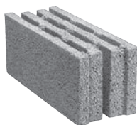
Size: 49×19×20 Max. Weight: 12.8 kg Sound Resistance: 53db دیواری توخالی ته‌پر (چهار جداره)
