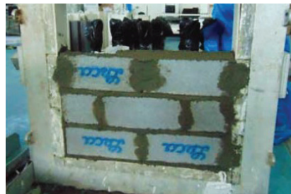
شکل ۱- اجرای دیوار با بلوک سیمانی لیکا و استفاده از ملات ماسه و سیمان در درز بلوک ها
