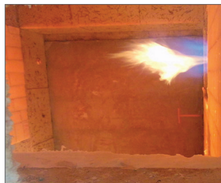
شکل ۷. سطح در معرض آزمونه در حین آزمون
