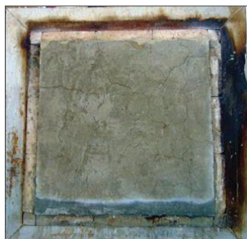
شکل ۸- سطح در معرض آزمون پس از سرد شدن
