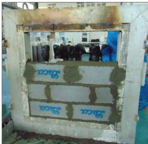
شکل ۲. اجرای دیوار با بلوک های سیمانی لیکا و استفاده از ملات ماسه و سیمان در درز بلوک ها
