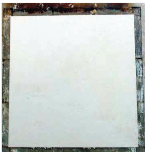
شکل ۴. اجرای اندود گچ به ضخامت ۳ سانتی متر بر روی سطح غیر معرض دیوار
