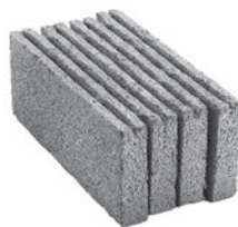
Size: 49×25×20 Max. Weight: 18.7 kg Sound Resistance: 54db دیواری توخالی (هشت جداره)
