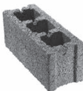
Size: 49×19×20 Max. Weight: 12 kg Sound Resistance: 47 db دیواری توخالی تمپر با سه سوراخ
