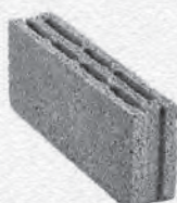
Size: 49×10×20 cm Max. Weight: 7.5 kg Sound Resistance: 47 dB تیغه‌ای توخالی ته‌پر (سه‌جداره)
