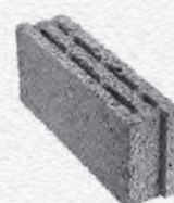
Size: 49×12×20 cm Max. Weight: 9.2 kg Sound Resistance: 49 dB دیواری توخالی (سم‌جداره)
