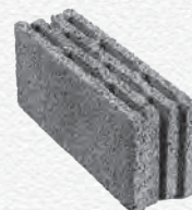
Size: 49×14.5×20 cm Max. Weight: 11 kg Sound Resistance: 51 dB دیواری توخالی (چهارجداره)
